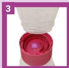
Setzen Sie die Probe mit Hilfe einer Pinzette und dem Mittelgrat des Stopfens auf das Gitter des Stopfens. Schrauben Sie den leeren Behälter wieder auf und achten Sie darauf, dass er fest verschlossen ist.
