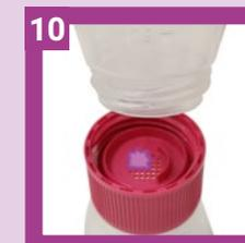
Nehmen Sie die auf dem Gitter zurückgehaltene Probe mit Hilfe einer Pinzette heraus.
