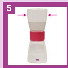
Appuyez sur le récipient supérieur jusqu'à ce que tout le liquide s'écoule dans le récipient inférieur par la valve bidirectionnelle. L'échantillon est immergé dans le formaldéhyde, ce qui déclenche le processus de fixation.
