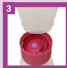
Placer l'échantillon dans la grille du bouchon, à l'aide d'une pince et de la bavure centrale du bouchon. Revisser le récipient vide en veillant à ce qu'il soit bien fermé.
