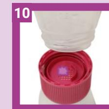
Collectez l'échantillon retenu dans la grille à l'aide d'une pince. L'échantillon est prêt à être traité.
